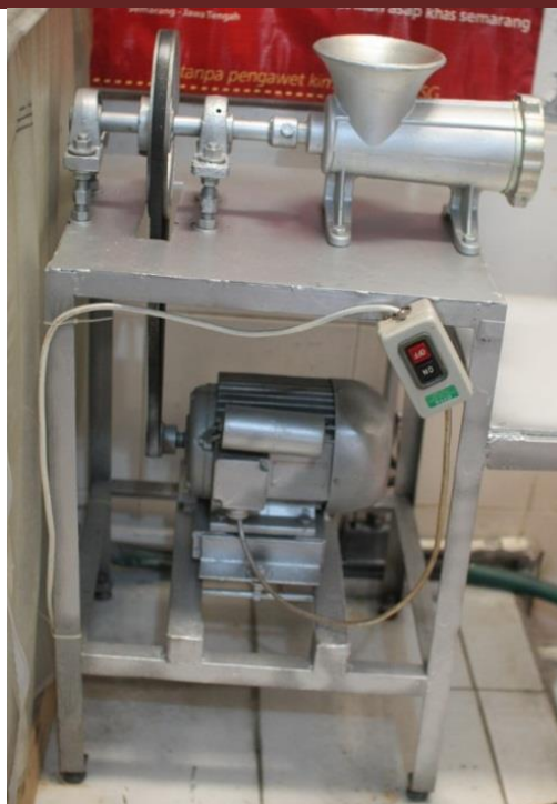
Gambar 2. Alat penggiling bahan baku sambal seafood
