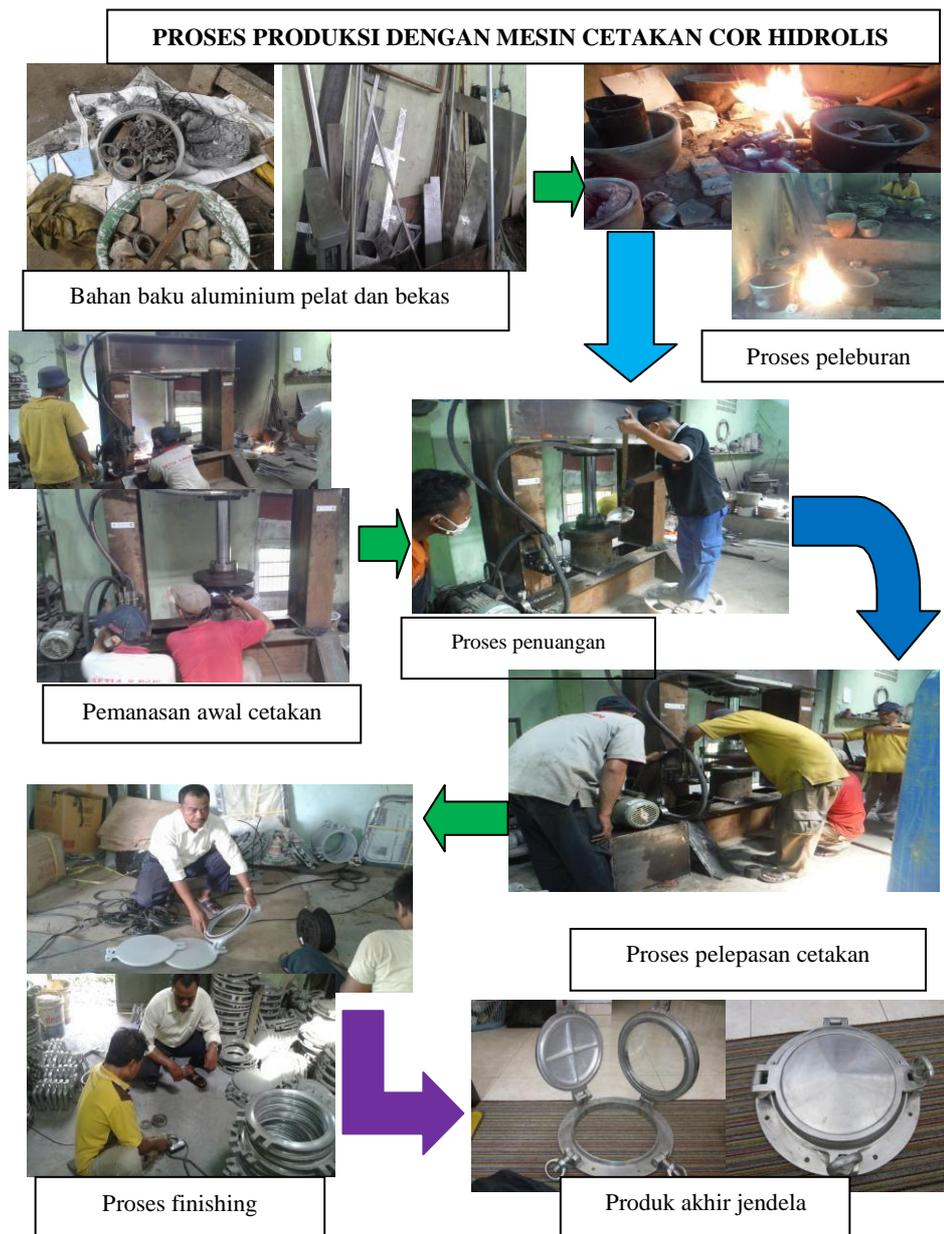
Gambar 2. Urutan proses produksi cendela aluminium dengan mesin cetakan cor hidrolis.
