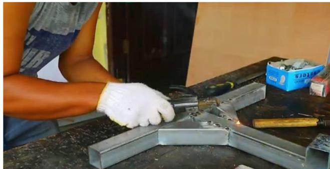
**Gambar 14. Proses Pengelasan**
