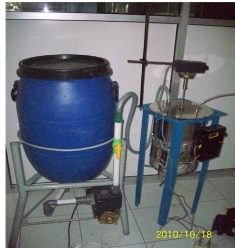
**Gambar E.1 Foto alat bioreaktor enzimatis**
