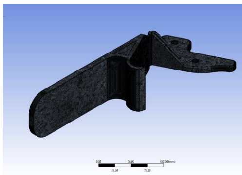
Gambar 5. Hasil meshing pada model yang digunakan.
