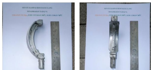
Gambar 7. Hasil pengecoran squeeze temperatur penuangan 700°C, diberi tekanan 194 MPa, suhu cetakan 300°C, dan penambahan TiB 0,07%
