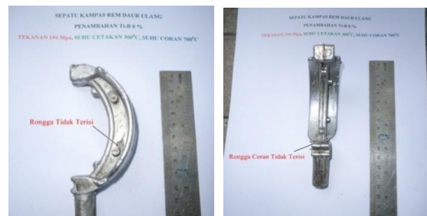
Gambar 4. Hasil pengecoran squeeze temperatur penuangan 700°C, diberi tekanan 194 MPa, suhu cetakan 300°C, dan tanpa penambahan Ti
