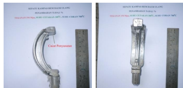
Gambar 5. Hasil pengecoran squeeze temperatur penuangan 700°C, diberi tekanan 194 MPa, suhu cetakan 300°C, dan penambahan Ti 0,02%
