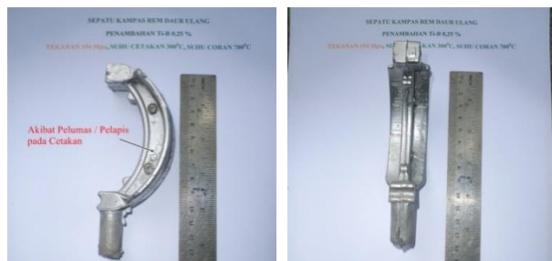
Gambar 6. Hasil pengecoran squeeze temperatur penuangan 700°C, diberi tekanan 194 MPa, suhu cetakan 300°C, dan penambahan Ti 0,05%
