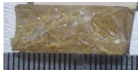
Gambar 7. Patahan komposit serat pelepah pisang
