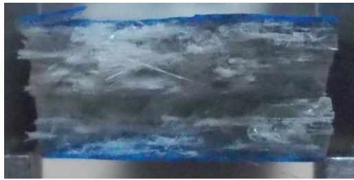
Gambar 10. Patahan komposit dashboard
