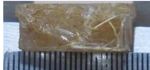
Gambar 6. Patahan komposit serat kelapa
