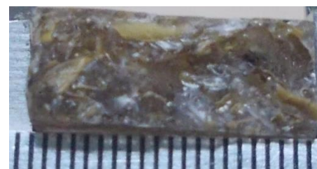
Gambar 8. Patahan komposit serat sekam padi
