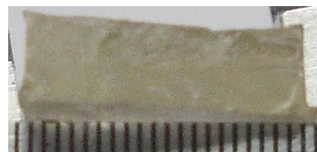
Gambar 9. Patahan komposit resin157 BQTN 100%
