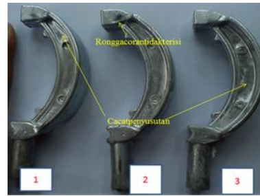
Gambar 3. Hasil Sepatu Kampas Rem Temperatur Cetakan 200°C
