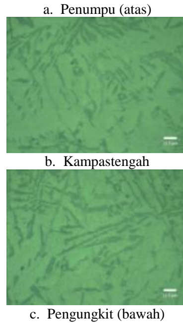
Gambar 13. Struktur Mikro Bagian Tepi Spesimen dengan Temperatur Cetakan 400°C
