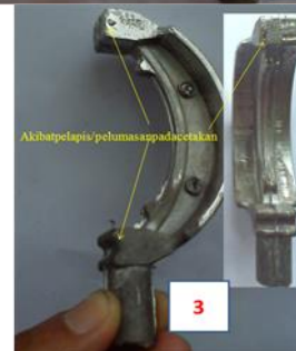
Gambar 5. Hasil Sepatu Kampas Rem Temperatur Cetakan 400°C
