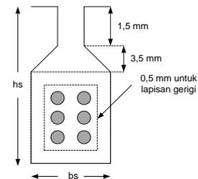
**Gambar 2. Konfigurasi slot rotor**
