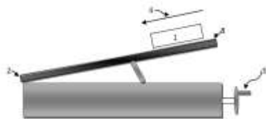
Gambar 7. Sketsa alat pengujian koefisien gesek bidang miring.
