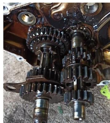
**Gambar 4. Pemasangan gigi Persneling**
