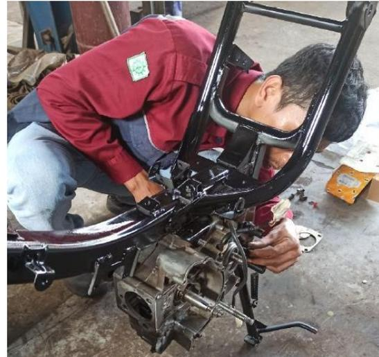
**Gambar 3. Pemasangan Mesin**
