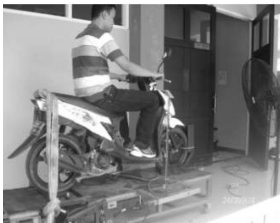
Gambar 2 Simulasi beban jalan pada dynamometer chassis sepeda motor
