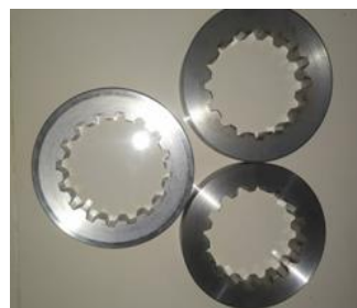
Gambar 3. Spline Spesimen Sebelum Induksi
