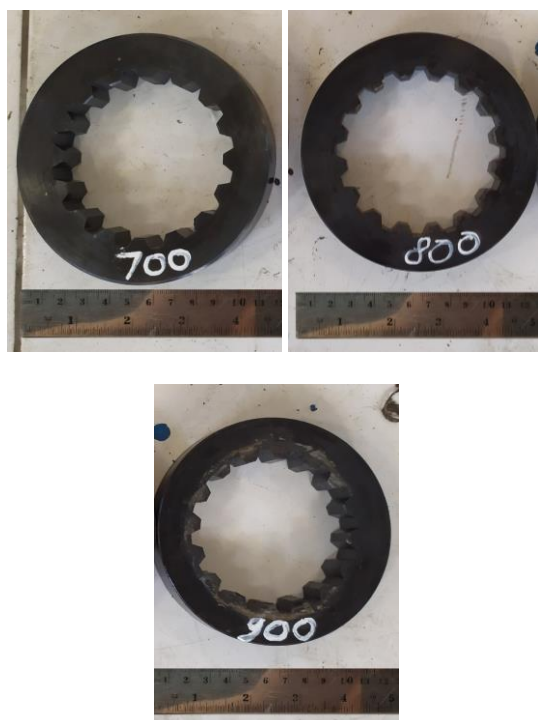
Gambar 4. Hasil Perlakuan Panas Pada Spline Nomor 1, 2 dan 3
