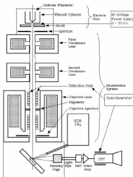
Gambar 2. Mikroskop Scanning Elektron dan skemanya (sumber : Khan, E.B)
