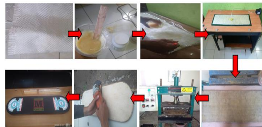
Gambar 3. Tahapan pembuatan sandwich komposit serat E-glass matrik epoxy
