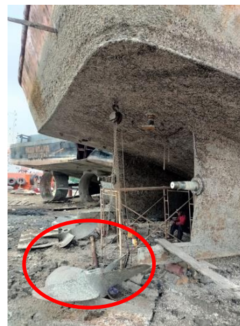
Gambar 1. Baling-baling yang dilepas dari poros propeller
