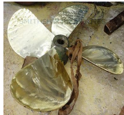
Gambar 10. Baling-baling yang sudah selesai balancing
