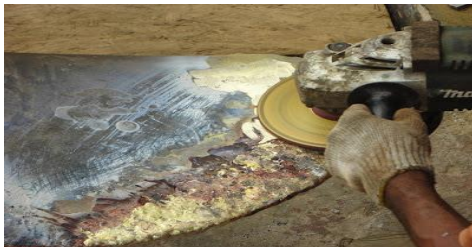
Gambar 7. Proses Penggerindaan fouling dalam hal ini proses Penggerindaan jangan sampai mengenai daun propeller .
