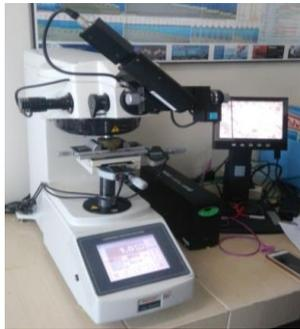
**Gambar 4.** Alat uji *Vickers*
