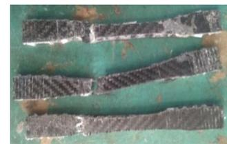
**Gambar 12. Patahan komposit karbon sandwich honeycomb 1 lapisan**
