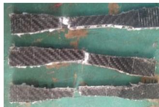
**gambar 13. Patahan komposit karbon sandwich honeycomb 2 lapisan**
