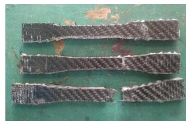
**Gambar 14. Patahan komposit karbon sandwich honeycomb 3 lapisan**
