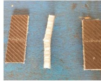
**Gambar 11. Patahan komposit karbon sandwich core honeycomb 3 lapisan atas**
