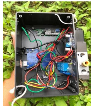
Gambar 9. Proses Pembuatan Hardware dalam Box Panel
