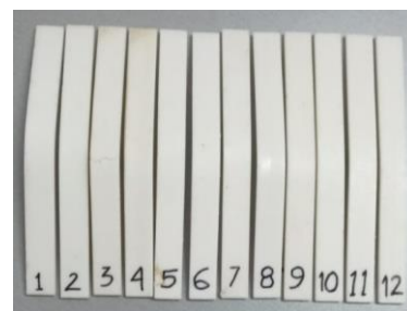
Gambar 10. Hasil Pengujian dua belas (12) Spesimen Uji ASTM D790
