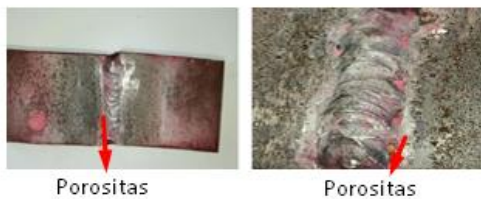
Gambar 8. Sampel Uji Setelah Penetran 120A
