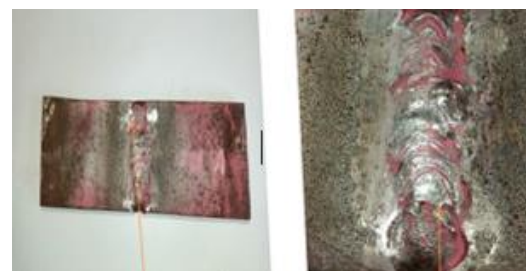
Gambar 6. Sampel Uji Setelah Penetrant 100A
