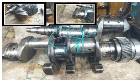
Gambar 2. Bentuk patahan crank shaft mesin penggerak generator
