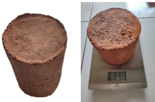
Gambar 1. Keramik berpori dari bahan tanah liat
