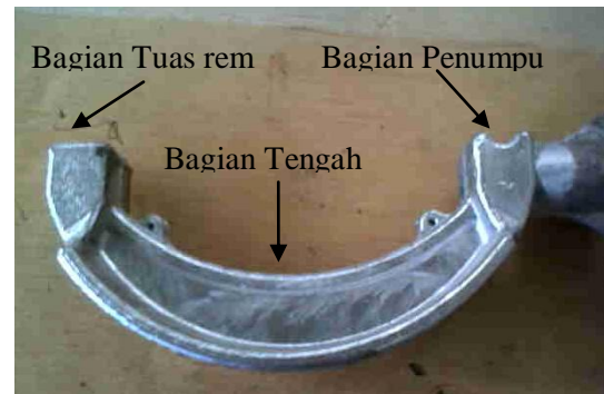
Gambar 4. Pengecoran Squeeze Tekanan 251,43 MPa
