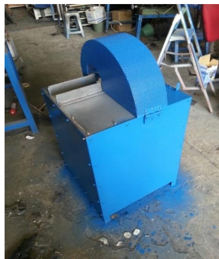
Gambar 3. Desain Alat Perajang Kerupuk Rumput Laut
