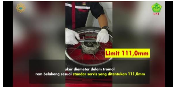
Gambar 4. Tambahkan Pemeriksaan keovalan pada tromol rem
