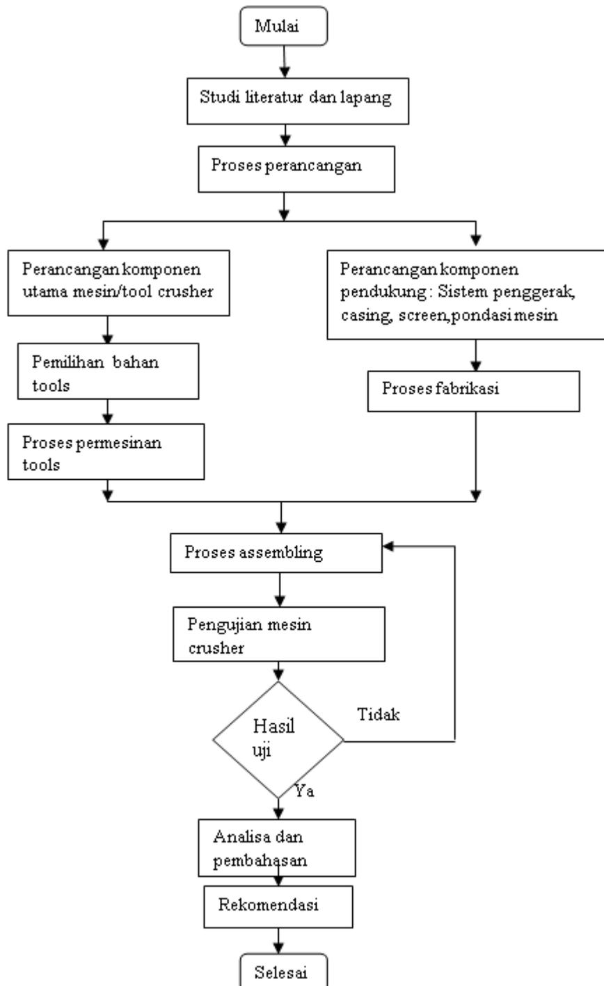
Gambar 1. Alur pembuatan mesin perajang kain untuk bahan serat komposit.
