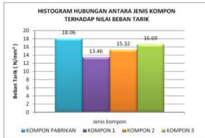
Gambar 2. Hasil pengujian tarik kompon
