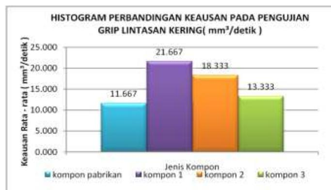
Gambar 3. Perbandingan keausan pada pengujian lintasan kering
