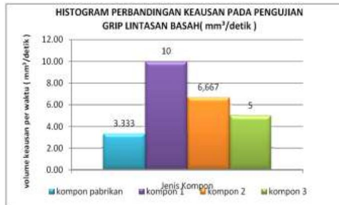
Gambar 4. Perbandingan keausan pada pengujian lintasan basah
