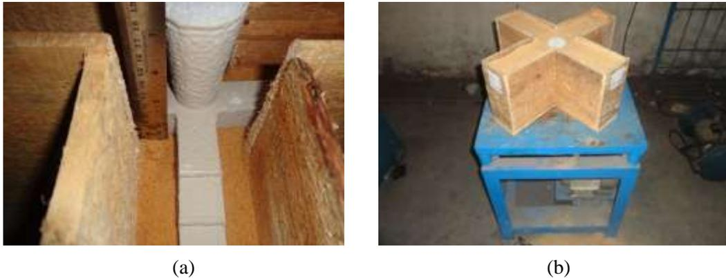
**Gambar 4. Penempatan pola pada cetakan (a) dan proses penggetaran cetakan (b)**
