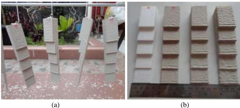
**Gambar 2. Proses pengeringan (a) dan variasi ketebalan lapisan pola EPS (b)**
