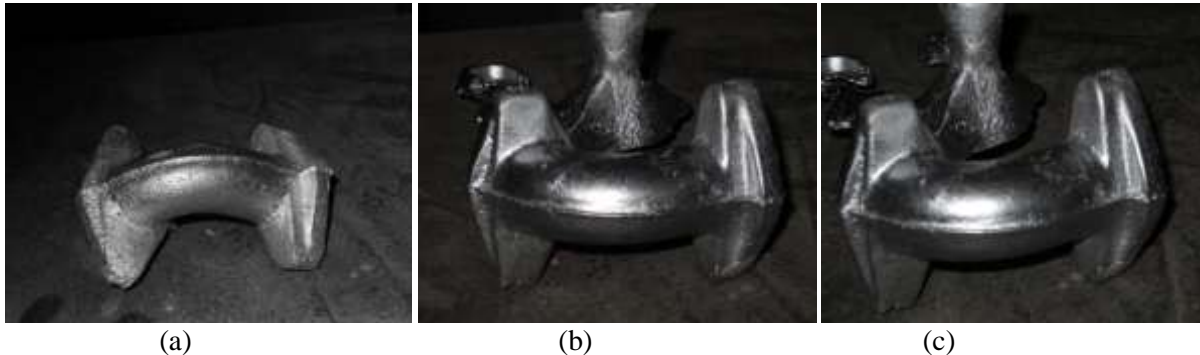
Gambar 6. Dokumentasi benda cor (a) 40% (b) 30% dan (c) 20% butir pasir mesh 200
