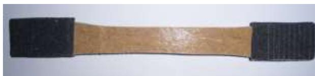
Gambar 1. Spesimen uji tarik
