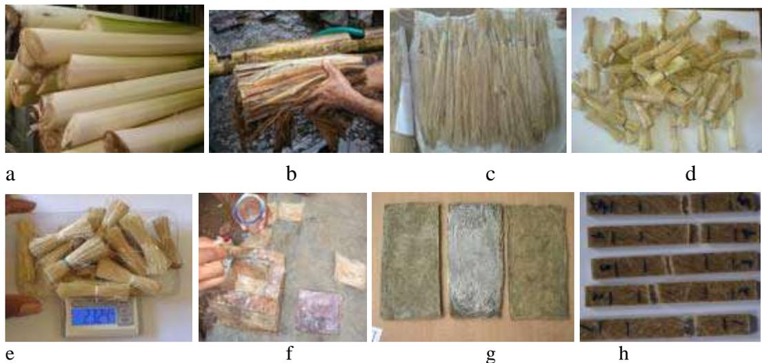
Gambar 1. a). Batang Pisang, b). Batang Pisang diserut, c). Serat Pisang, d). Serat yang telah dipotong, e). Penimbangan serat, f). Pencetakan Komposit, g). Spesimen Komposit, h). Spesimen Uji *Bending*.
