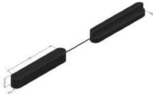
**Gambar 1. Spesimen uji pullout**
