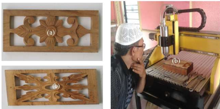
Gambar 3. a) Hasil ukir otomatis b) Mesin ukir kayu otomatis
