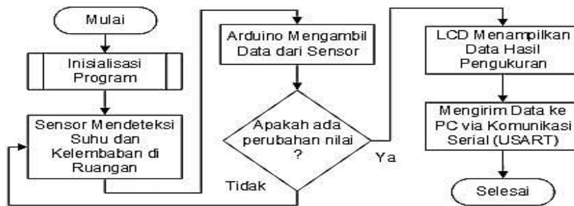
Gambar 6. Flowchart Cara Kerja Perangkat Keseluruhan
