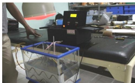
Gambar 6. Konfigurasi pengukuran phantom menggunakan Short wave Diathermy
