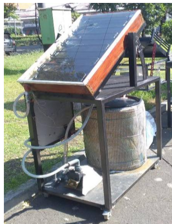
Gambar 2. Solar water heater dengan sudut kemiringan
