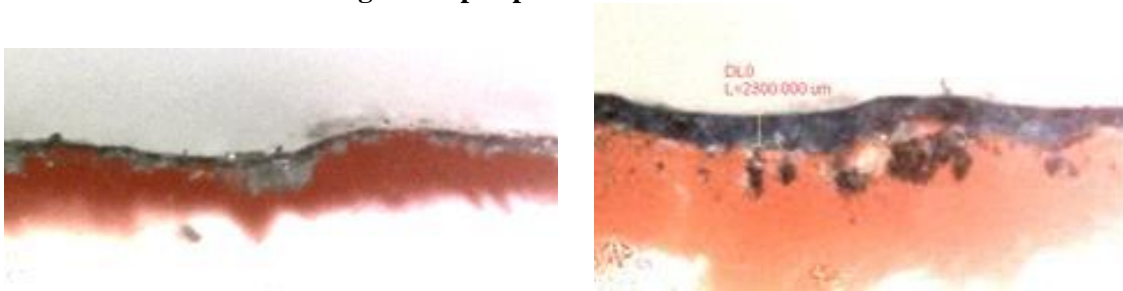
Gambar 4. Spesimen dengan fill density 20%, Perbesaran 250x, enam kali pelapisan cat dan satu kali Pelapisan RenGel resin
