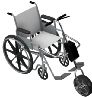
Gambar 3. TRIKE ketika terintegrasi dengan kursi roda
