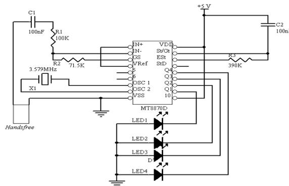
Gambar 3 Rangkaian pengujian IC MT8870
