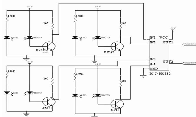
Gambar 4. Rangkaian pengujian *sensor* kartu
