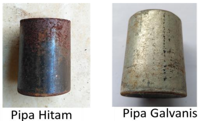
Gambar 4. Spesimen yang telah terkorosi.
