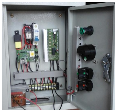
Gambar 4. Rangkaian sistem kendali inverter gelombang kotak
