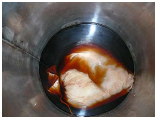
Gambar 1. Maserasi sampel dengan etanol 70%
