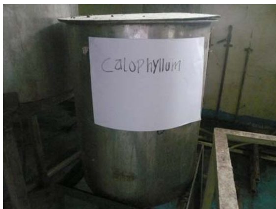
Gambar 1. Maserasi sampel dengan etanol 70%
