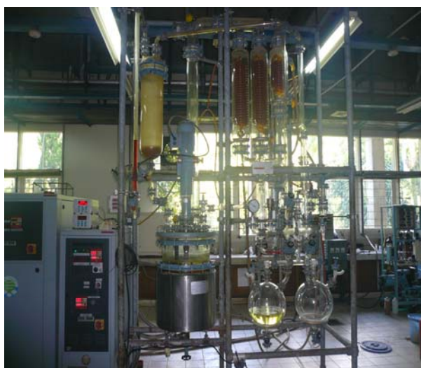
Gambar 2. Pemekatan hasil maserasi dengan evaporator.
