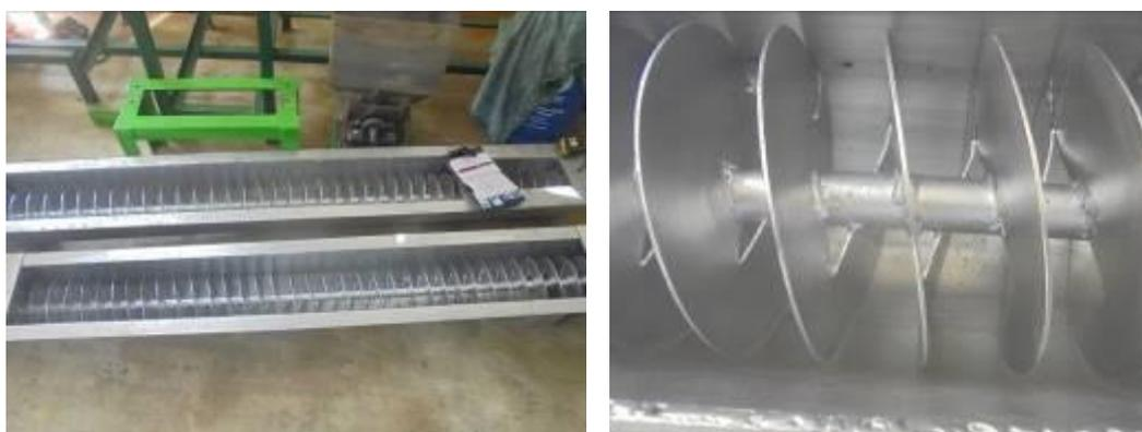
**Gambar 5. Bentuk *screw conveyor***
