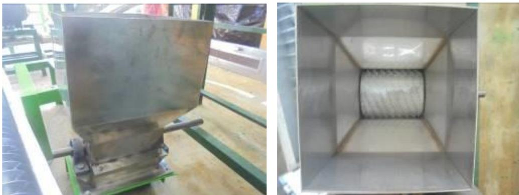
**Gambar 4. Bentuk hoper dengan silinder bergigi**
