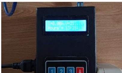
Gambar 7. Hasil tampilan hardware dan pembacaan sensor arus
