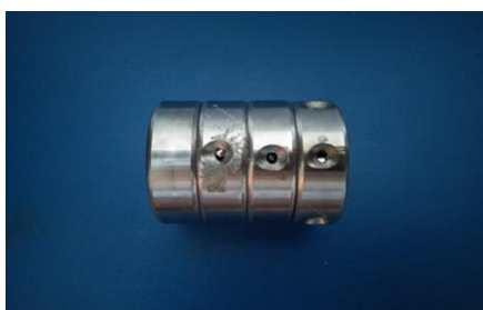
Gambar 3. Konstruksi kerusakan outer pada bearing motor induksi
