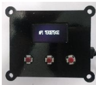
Gambar 5. Tampilan notifikasi node sensor kebakaran
