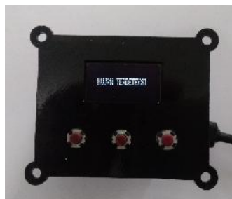
Gambar 6. Tampilan notifikasi node sensor hujan
