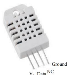
Gambar 4. Tampilan Fisik dan Konfigurasi DHT22
