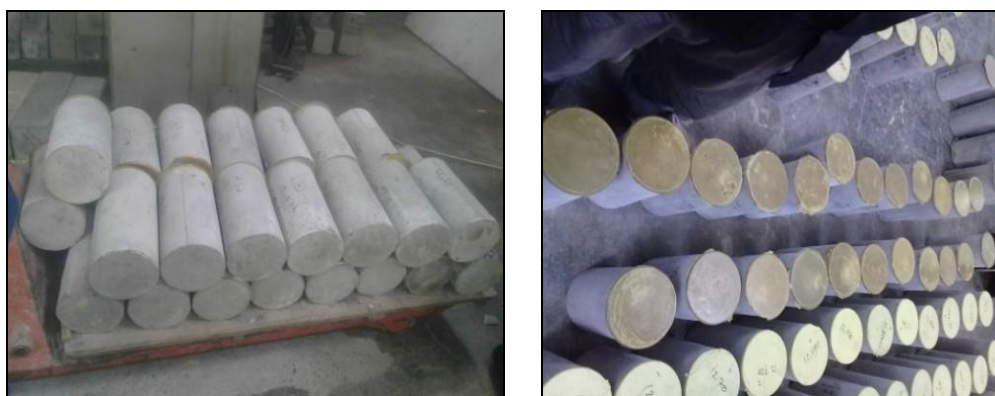
Gambar 3.1. Beton Sebelum Dan Sesudah Diuji Kuat Tekan
