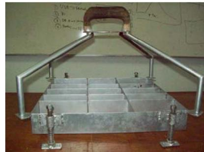
**Gambar 3** Hasil Rancangan pertama Alat Pemotong Tahu
